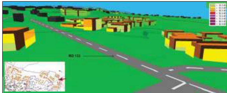
Figure 26 : Cartographie des niveaux sonores en façade des bâtiments projetés, période diurne 6h-22h
