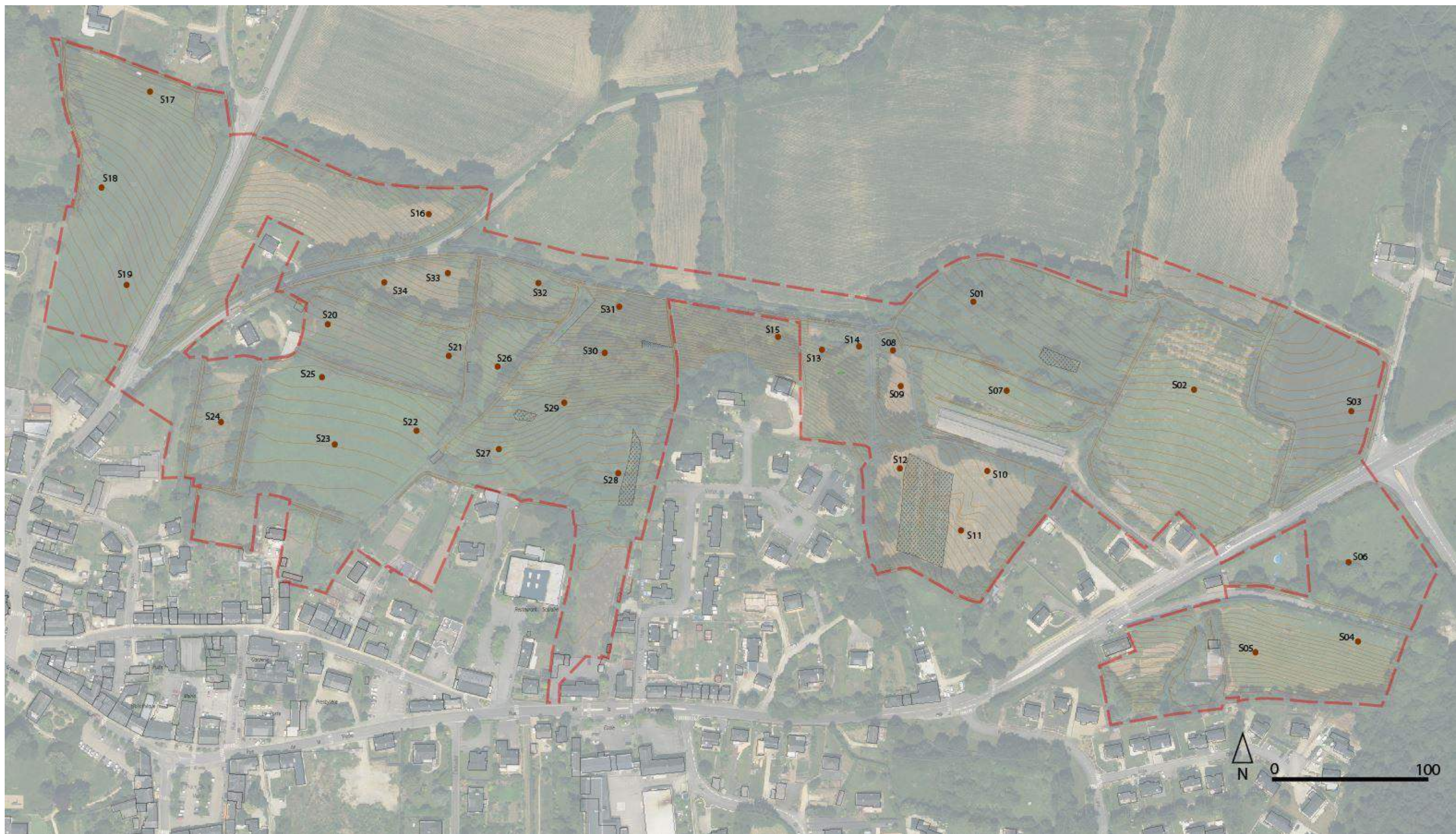
Figure 26 : Localisation des sondages pédologiques réalisés sur site
